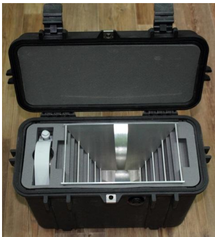
Фото 3. Антенна П6-123 в пыле-влагозащитном противоударном корпусе
